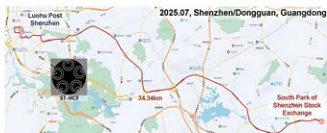
图：我国“首个”反谐振空芯光纤商用线路，损耗达到0.085dB/km
